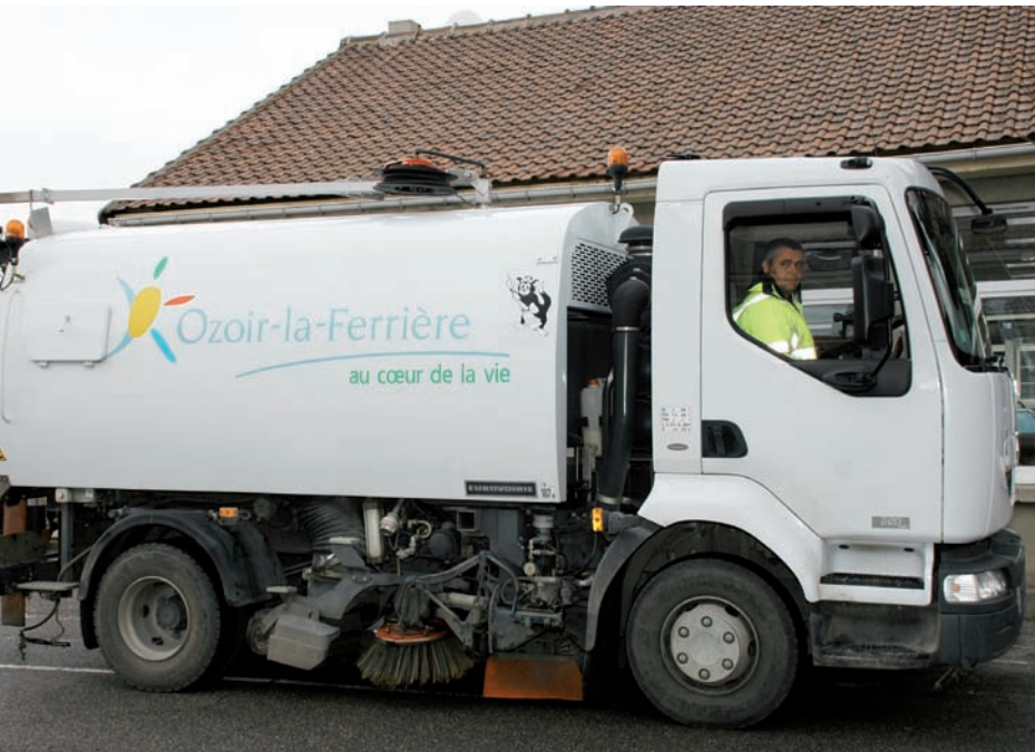
La balayeuse de grande capacité : le réservoir contient 700 litres.
