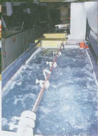
Bain électrolytique: les lois de l'électrolyse ont été établies il y a plus d'un siècle; depuis lors le processus n'a cessé de se perfectionner.
