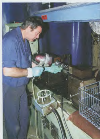
La recherche d'éventuels défauts microscopiques de surface s'effectue à l'aide d'une lampe à rayons U.V. et d'un produit fluorescent dont on enduit les pièces à vérifier...
