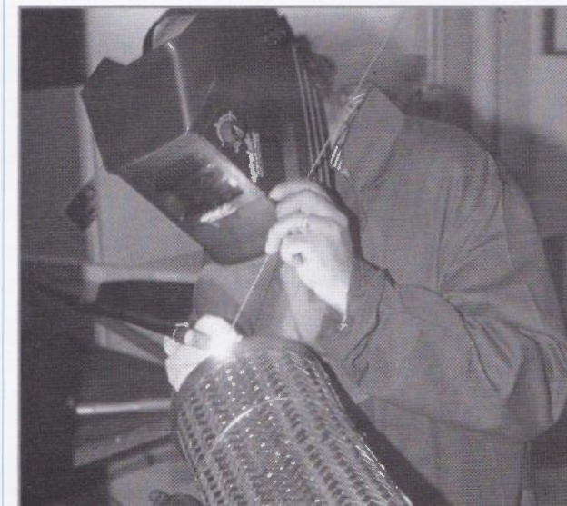
Soudure manuelle sur une grosse tuyauterie destinée à E.D.F. Dans certaines soudures, dites «par orbitale», l'électrode tourne autour de la pièce assurant une qualité de travail que le meilleur des ouvriers ne pourrait atteindre.
