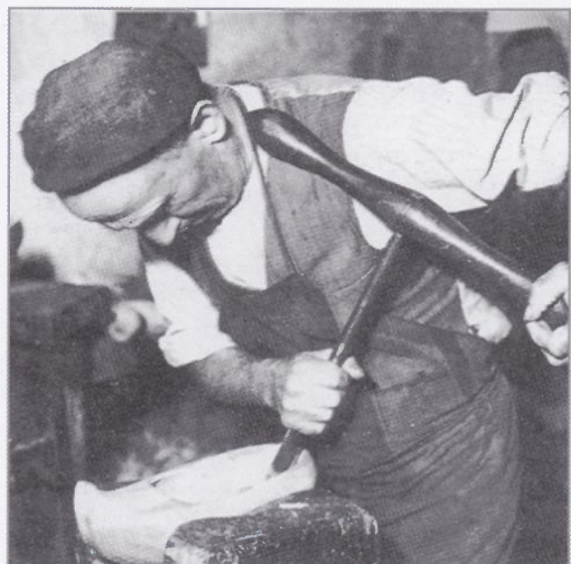
Autrefois, le fabricant de sabots chaussait presque tous ses concitoyens. Il conservait des patrons en papier à la taille des pieds de ses clients et taillait les sabots avec des outils traditionnels comme la gouge que l'on voit sur cette photo.
